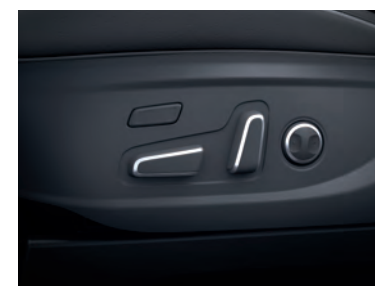
Водительское сидение с электроприводом для регулировки в 8 направлениях и регулировки опоры поясничного отдела в 2 направлениях
