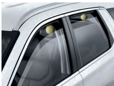
Стеклоподъемники с электроприводами и защитными устройствами
