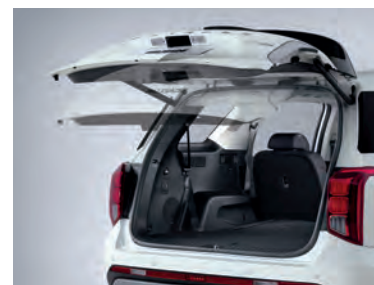
Система электропривода двери багажника автомобиля
