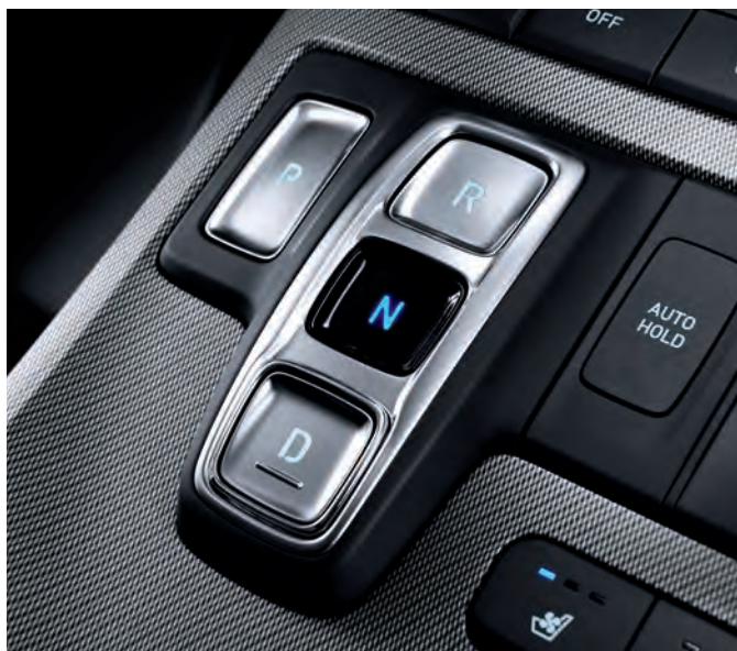
8-ступенчатая автоматическая коробка передач с кнопочным управлением
