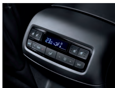
Трехзонная автоматическая система кондиционирования с независимым управлением
