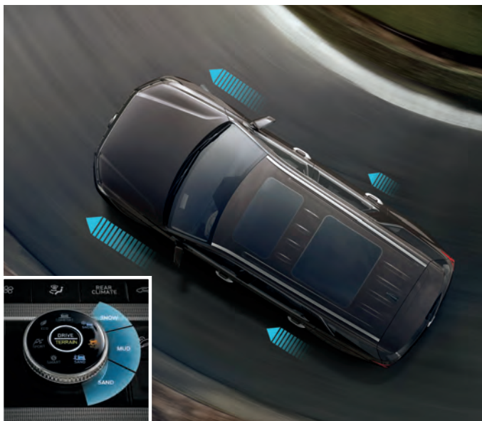
HTRAC Система управления полным приводом HTRAC и система выбора внедорожных режимов движения Multi-Terrain Control
